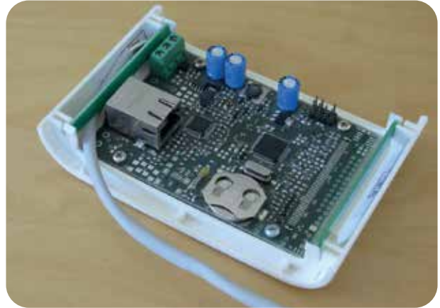
Inserire due supporti a destra e sinistra del pannello
