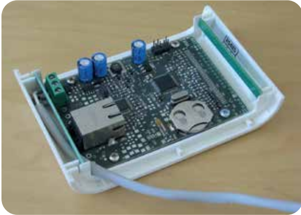
Inserire due supporti a destra e sinistra del pannello
